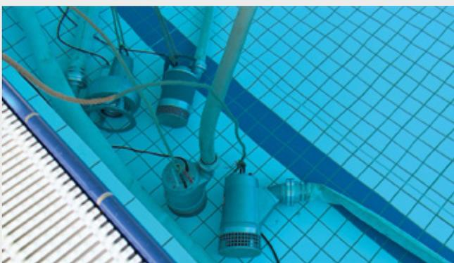
Vier Pumpen mit einer Gesamtleistung von 5.000 Litern pro Minute beförderten das Wasser aus dem Schwimmbecken in die großen Fässer der Landwirte.
