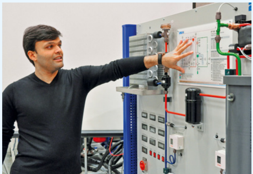
Prof. Dr.-Ing. Haresh Vaidya erklärt am Versuchsstand die Funktionsweise einer Wärmepumpe.
