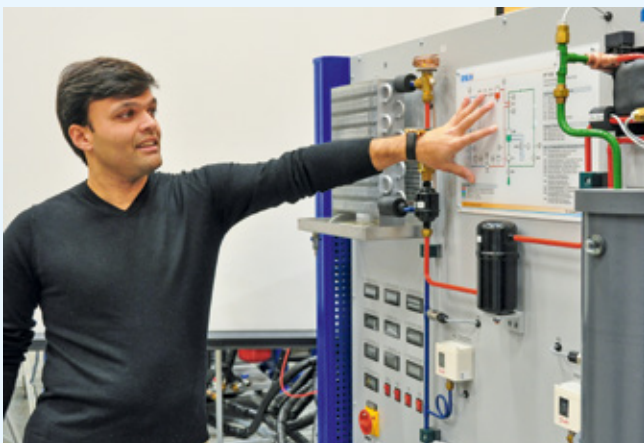
Prof. Dr.-Ing. Haresh Vaidya erklärt an einem der zahlreichen Versuchsstände am Campus die Funktionsweise einer Wärmepumpe.
