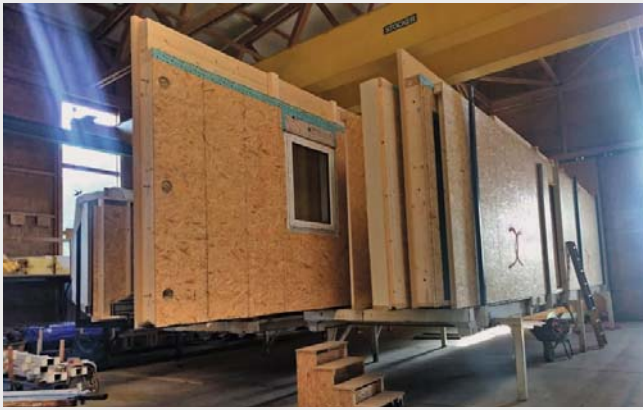
Ein Großteil der Bauelemente ist bereits für den Transport nach Feuchtwangen bereit. Die Außenwände des Mehrfamilienhauses sind bei der Anlieferung auf die Baustelle mit dem gedämmten Holzständerwerk, einer Holzwerkstoffplatte auf der Innenseite und einem Putzträger inklusive einer Kratzputzschicht auf der Außenseite sowie mit Fenstern und Rollläden ausgestattet.
